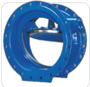
**A farfalla** DN 200 - DN 1000 PN 10 - 16 - corpo e disco in ghisa sferoidale - sede tenuta su corpo e disco in nichel microfinito - scartamento secondo le EN 558-1 serie base 14 - eventuale dispositivo di frenatura interno - rivestimento interno ed esterno con verniciatura epossidica.
