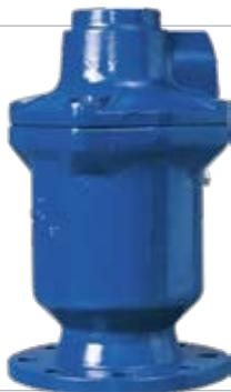
**DN 50 - DN 300 PN 10 - 16 - 25 - 40** - a singola camera con singolo orifizio per funzioni di degasaggio - a doppia camera con doppio orifizio per triplice funzione: scarico, rientrata d'aria e degasaggio - a singola camera con doppio orifizio per triplice funzione: di scarico, rientrata d'aria e degasaggio - corpo e coperchio in ghisa grigia o sferoidale - galleggiante in acciaio inossidabile o rivestiti in gomma - rivestimento interno ed esterno a polveri epossidiche
