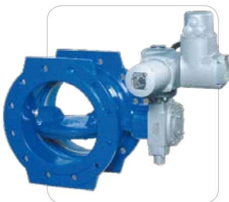
**Valvole a farfalla flangiate** DN 150 - 2400 PN 10 - 16 - 25 - 40 - corpo e disco in ghisa sferoidale od in acciaio eletrosaldato - sede tenuta in nichel microfinito - guarnizione in gomma EPDM - alberi in acciaio inox - rivestimento interno ed esterno a polveri epossidiche - scartamento secondo le EN 558-1 serie base 14 - con riduttore di sforzo a vite senza fine irreversibile e volantino - motorizzate o predisposte per futura motorizzazione.
