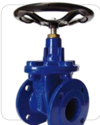
**Saracinesche a cuneo metallico** DN 40 - 1200 PN 6 - 10 - 16 - 25 - 40 - 64 - A vite interna o vite esterna - a corpo piatto - ovale o cilindrico - scartamento secondo le EN 558-1 serie base 14/15/26 - corpo in ghisa grigia o ghisa sferoidale - interni in ottone o acciaio inox - Rivestimento interno ed esterno con resine sintetiche e/o epossidiche - manuali, predisposte per la motorizzazione e/o motorizzate
