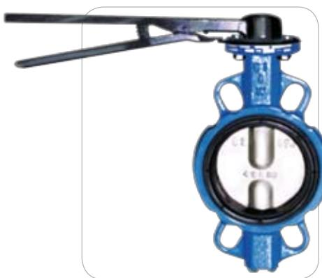
**Valvole a farfalla - Wafer e Lug** DN 50 - 1000 PN 10 - PN 16 - corpo in ghisa sferoidale - disco in ghisa sferoidale oppure in acciaio inossidabile (altro a richiesta) - rivestimento interno corpo in EPDM / NBR - alberi in acciaio inossidabile - scartamento secondo le EN 558-1 serie base 20 - comando a leva a gradini o a mezzo di riduttore a vite senza fine e volantino - comando con attuatore elettrico o pneumatico
