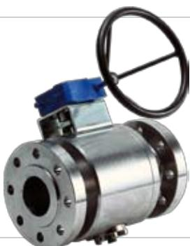
**DN 15 - DN 1000 serie UNI o ANSI** - Tipo trunnion o slip-on - valvole a sfera a passaggio totale o parziale - corpo in acciaio al carbonio nichelato o acciaio inossidabile AISI304 o AISI316 - sfera in acciaio al carbonio nichelato o inossidabile AISI304 o AISI316 - sede di tenuta in PTFE o metallica - albero di comando in acciaio inossidabile - comando manuale a mezzo riduttore a vite senza fine e volantino - comando elettrico o pneumatico o oleodinamico.
